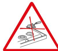
Le contact direct de plâtre ou de colle pour plaques de carreaux de plâtre avec la sous-face du receveur est à proscrire. Il ne doit pas y avoir de blocage vertical ni latéral du receveur.
